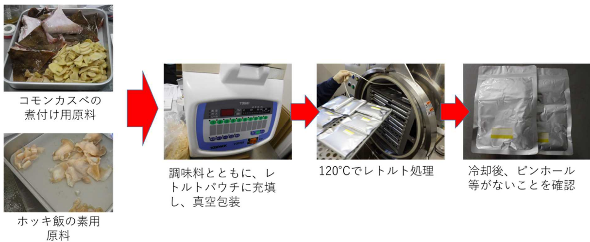
図 2 レトルト試作品の製造工程
