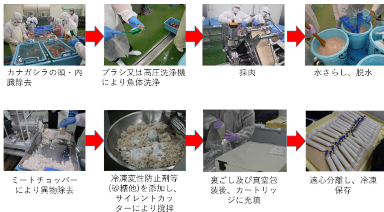
図 1 3D フードプリンター用素材の製造工程
