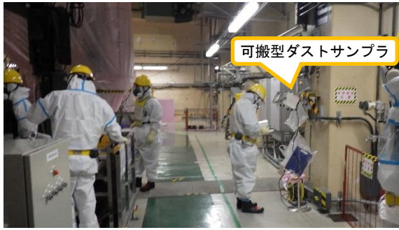
(写真2) 可搬型ダストサンプラによる ダストの採取状況 (南側から撮影)
