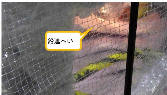
(写真2-2) H I C上に置かれた鉛遮へい 下には改良遮へいが置かれている。
