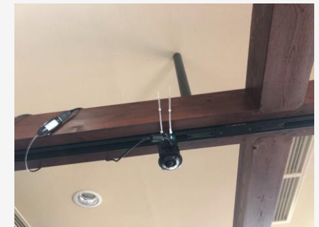
天井の梁に魚眼カメラでARマーカを認識してロボット位置を推定する
