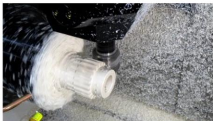
5軸制御NC旋盤での主軸-エンドミル同期による加工
