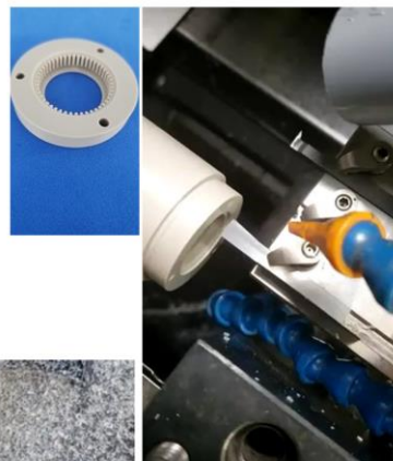
C軸制御NC旋盤にてスロッターによる加工
