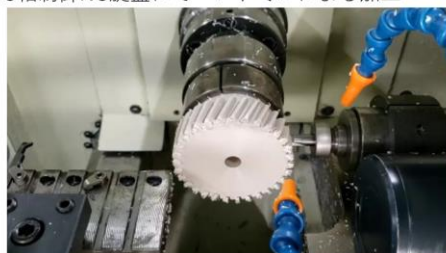
5軸制御NC旋盤での主軸-エンドミル同期による加工
