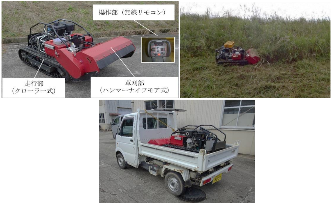
図1 開発機の写真（左：外観、右：作業の様子、下：軽トラックに車載された様子）
