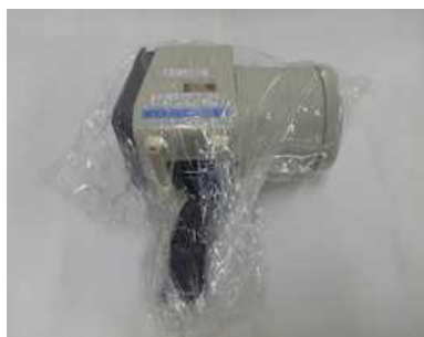
電離箱式サーベイメータ (ガンマ線(高線量率)測定用)
