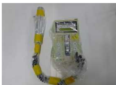
Na I (Tl)シンチレーション式サーベイメータ (ガンマ線(低線量率)測定用)
