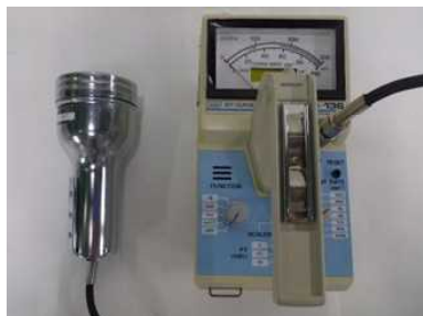
GM管式サーベイメータ (表面汚染検査用、主としてベータ線をカウント)
