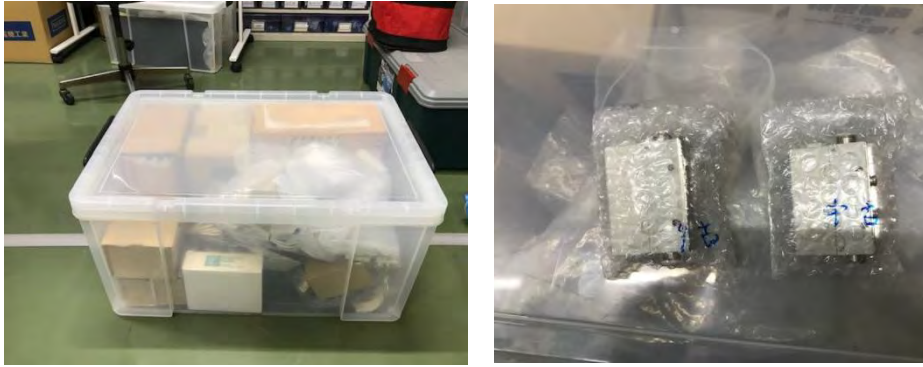
図5 保管容器の写真（左）及び保管容器内におけるデジタル流量計の保管状態（右）
