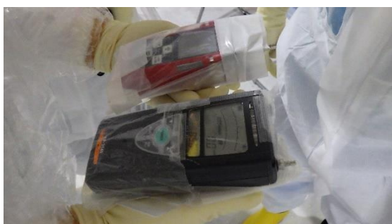
(写真5) 放出ガス内の水素、酸素、硫化水素を測定するポータブル測定器 (手前が水素用、奥が酸素、硫化水素用)
