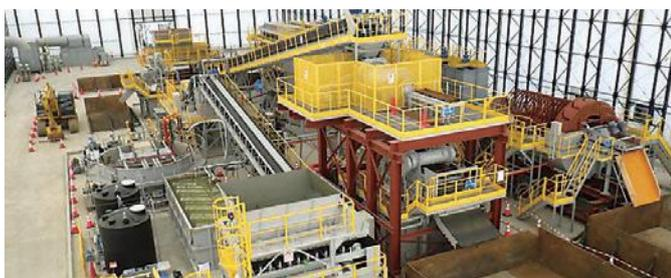
放射性セシウムが粒度の細かい土壌に付着しやすい性質を利用して、除去土壌を写真の機械で粒径別にふるい分けることにより、放射能濃度の高いシルトや粘土と濃度の低い礫や砂に分離する技術。
