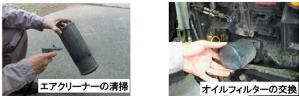
図3 エンジンの保守点検の例（トラクター、コンバイン等）
