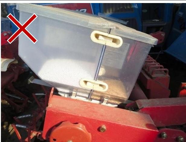
播種機や肥料散布機の中に肥料を残したまま放置すると、固化、劣化して詰まりや機械の故障の原因にもなります。
