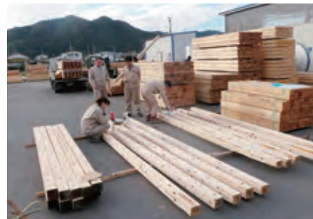
製材品の表面線量調査の様子
