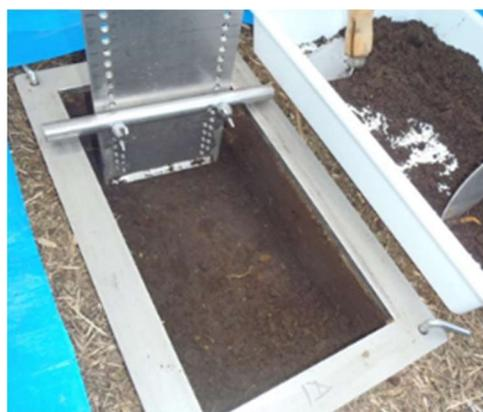
図1 土壌採取で用いたスクレーパープレート
