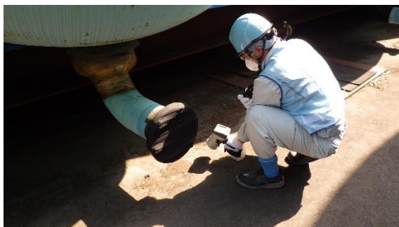
(写真3-2) ブルータンク周辺の地表面の線量率 測定の例
