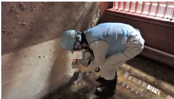
(写真2) 取水路床面の汚染を測定している様子
