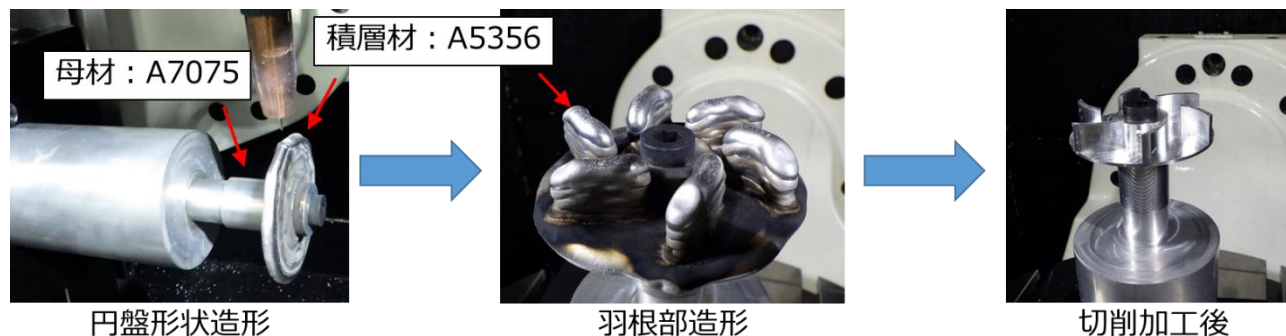
図2 試作したインペラ形状
