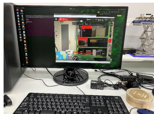
図10 AI環境と映像伝送統合実験 (上) ドローンによる撮影 (下) 伝送先での物体検出
