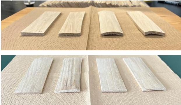
図2 サワグルミ材の樹脂溶液含浸乾燥後の状態
