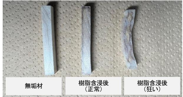
図4 サワグルミ材の樹脂溶液含浸乾燥後の断面
