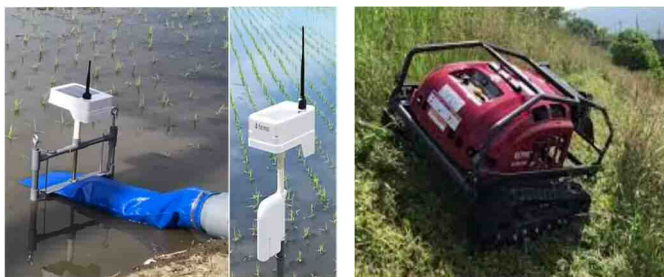
水位安定化による雑草抑制、畦畔除草の効率化 (自動水管理システム、自走リモコン草刈機)
