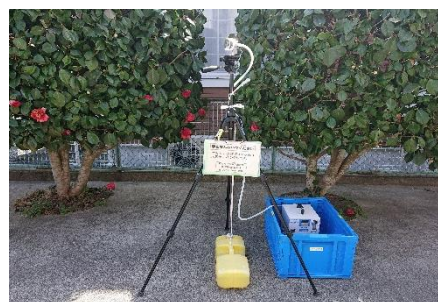
〈環境大気中のアスベスト濃度調査における試料採取の様子〉
