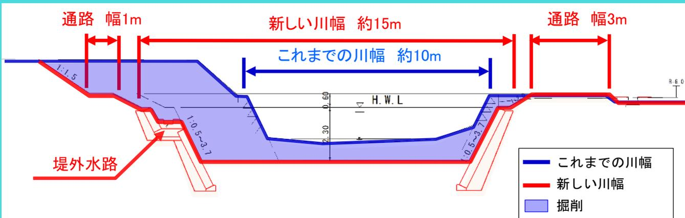
全区間において、上図に示す新しい河幅は確保しており、必要な流下能力は確保しています。
