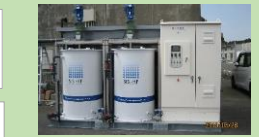
水産物の高鮮度保持技術 (シャーベット水製造装置)
