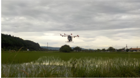
ドローンを用いた除草剤散布の様子
