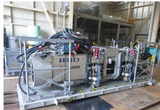
堆積物除去装置 (高圧水・AWJ) 外観
