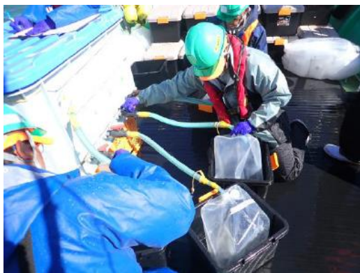
東京電力福島第一原子力発電所沖でH-3分析用の表層海水試料を採取しているところ
