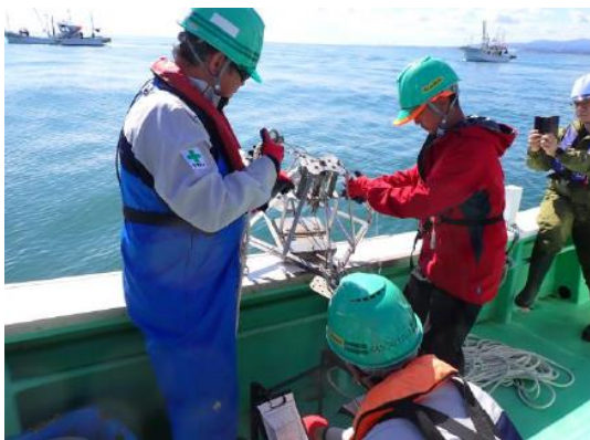
東京電力福島第一原子力発電所沖で採泥器により 海底土試料を採取しているところ
