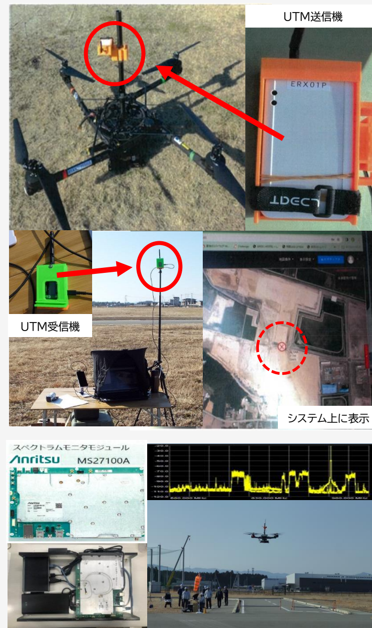
スペクトラムアナライザ小型モジュール RTF上空の電波測定と取得データ(上)
