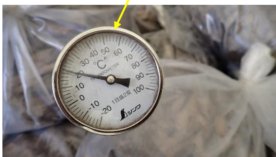
(写真8-2) 金属製1 m 3 コンテナ内の温度測定状況② (約20℃、外気温と同程度)
