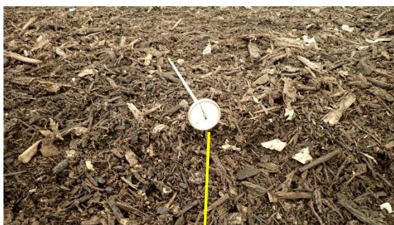
(写真3-1) 伐採木チップ内の温度測定状況①
