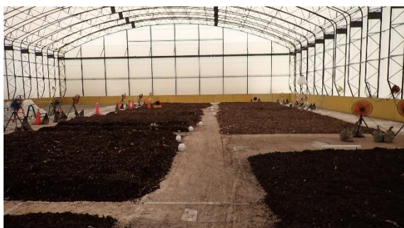
(写真2) エリア分けされた伐採木チップ一次乾燥の状況
