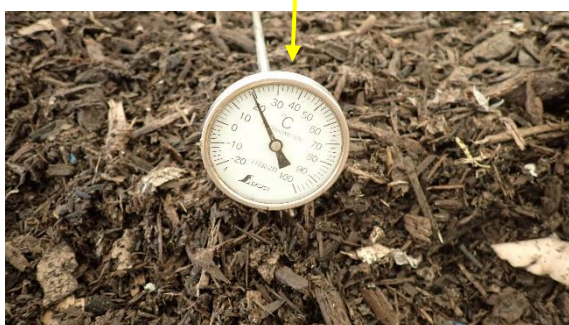
(写真3-2) 伐採木チップ内の温度測定状況② (約20℃、外気温と同程度)
