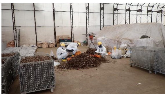
(写真5-1) 伐採木チップ一次乾燥後のふるいかけ作業状況
