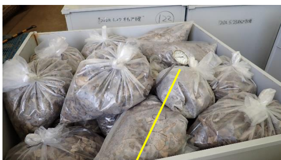
(写真8-1) 金属製1 m 3 コンテナ内の温度測定状況①
