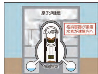
大量に発生した水素が、原子炉建屋内に漏れ出した。
