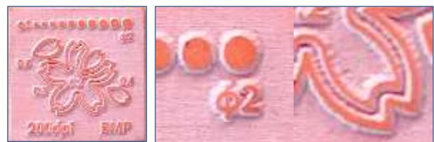
図4 解像度による加工結果の差(レーザー用ゴム)
