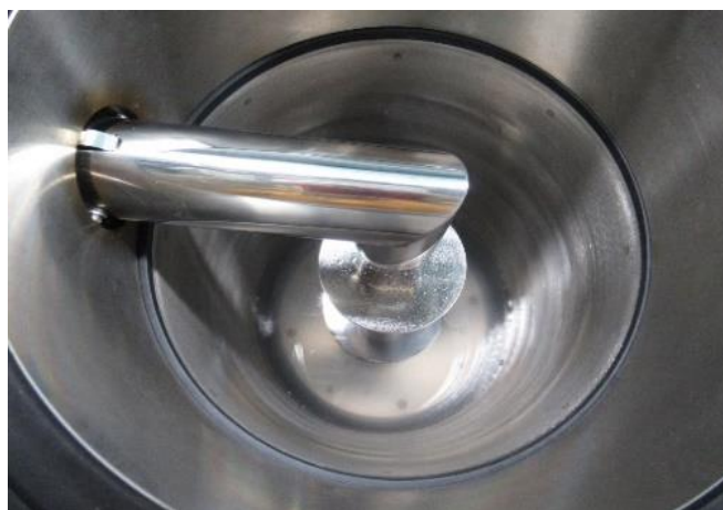
凍結した水分を解凍し回収
