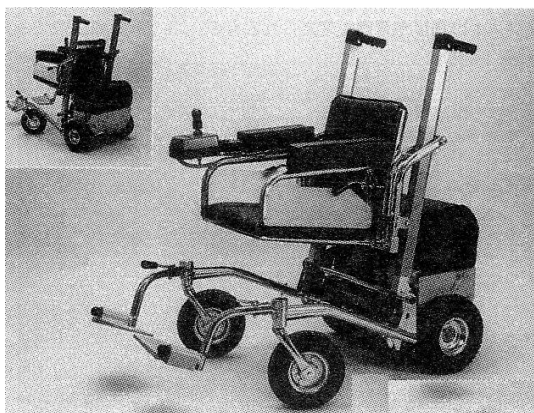
↑ 標準形 電動リフト機構
