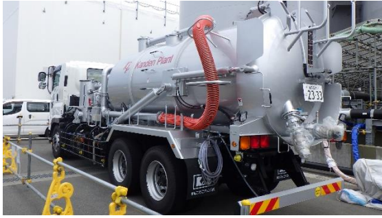
(写真3-2) パワープロベスターの状況 (移送されてきたタンク残水を収集するの に用いられる。)
