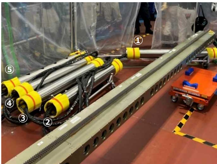
押し込みパイプ外観 (工場での模擬環境における作業訓練時) (2024年5月27日)
