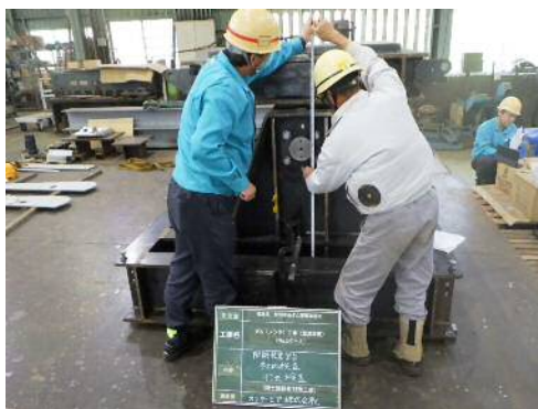
洪水吐き開閉器架台製作完了（R6 年度据付）
