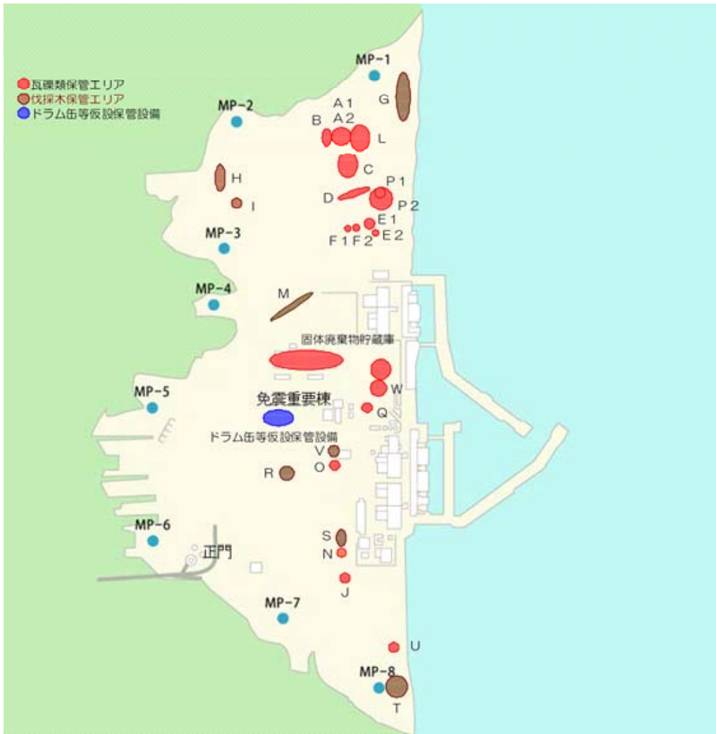
図1 福島第一原子力発電所構内のガレキ類等保管施設
