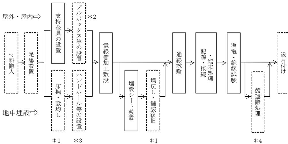
\*1は、作業土工（電気）による。なお、床掘時に舗装があれば取り壊しを計上する。
