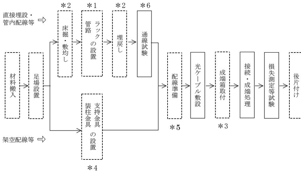
\*1は、屋内・屋外管路の敷設は、「第2章第1節①配管・配線工」及びラック取付は、「第2章第1節②配線器具設置工」による。
