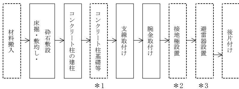
\*1 は、根入れが満足しないなど補強する場合及び、鋼管ポールなどによるベースプレート式の場合とし、作業土工（電気）による
