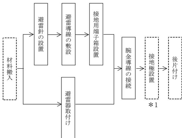
\*1は、「第2章第1節⑫接地設置工」による。
