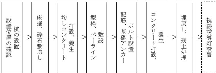
本作業は、作業土工（電気）による。
