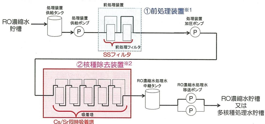
※1：SSフィルタは切替運転により1塔通水する
