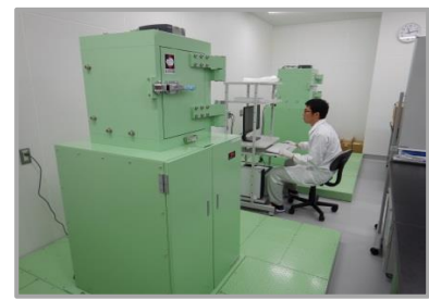
放射性セシウムの測定（ゲルマニウム半導体検出器）
