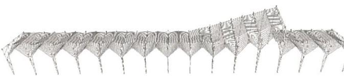
福島県産の一般流通材を用います。地元大工による長期的なメンテナンスも可能です。教育研修棟では、大工の手刻み技術とデジタル技術の融合を図ります。材長6m以下の小径木によるトラス構造とし、歩留まり良くローコスト化を図りながらダイナミックな架構を実現します。生活交流棟では、マッシュホールツ工法を採用します。材厚による遮音効果も期待できます。伝統と革新の共存と融合、大工技術の継承を図ります。
