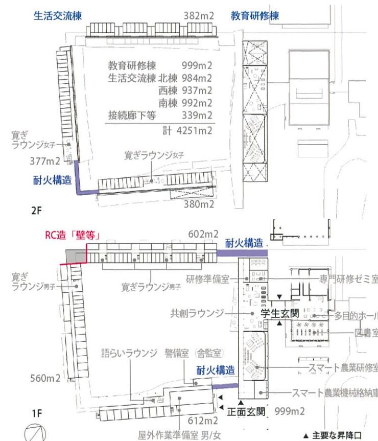
高さ16m以下に抑えます。ロノ字型配置の北西入隅部分にRC造の「壁等」を配置し、他の入隅部分には、幅3m以上の耐火構造を挟むことで別棟扱いとし、4,000m<sup>2</sup>を有効に区画します。区画された各部分は1,000m<sup>2</sup>以下とし、教育研修棟（用途：学校）は、一般流通材小径木の現し、生活交流棟（用途：寄宿舎）は、難燃木材を用いた内装制限（令114条）を行います。
