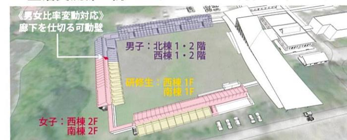
男子寮を北棟と西棟、女子寮と研修生・講師宿泊室を西棟と南棟に設けます。男子寮は1ユニット14室を基本とするメゾネット形式とします。女子寮は2階に配置し、セキュリティを高めます。西棟の男子寮2階の一部を女子寮の廊下につなげ、廊下を仕切る可動壁の位置を変えることで、高いセキュリティ度を維持したまま男女比率の変動に対応します。
