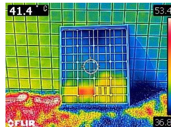
図3 加飾部の温度測定 (黒色シートが最も高温に)
