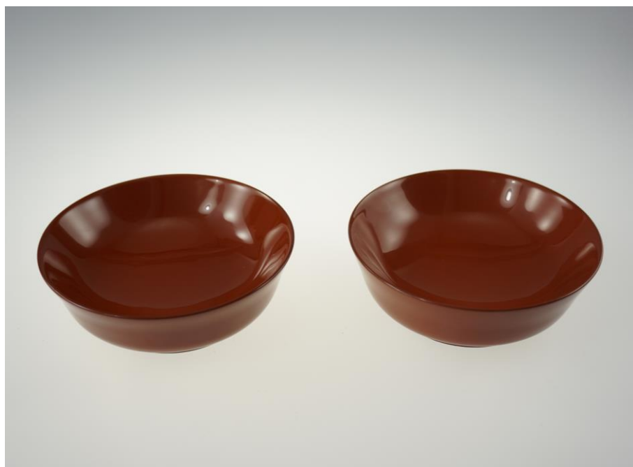
図1 食洗機で500回洗浄した後の漆器の一例 (左：新品、右：試験後)
