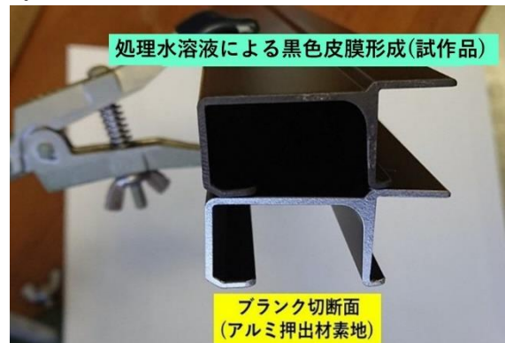
図4 処理水溶液により黒色化された様子
