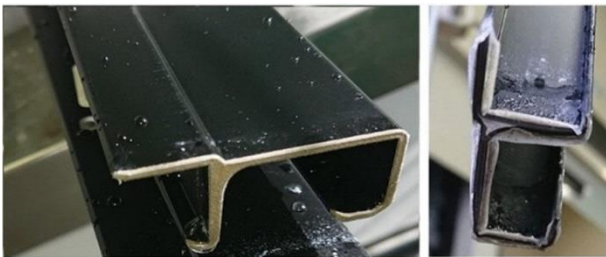
(a) 7 時間後 (b) 24 時間後 図6 浸漬時間の違いの様子
