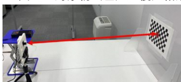
図4 カメラからチェックボードまでの距離測定
