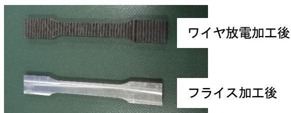
図10 作製した引張試験片
