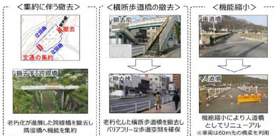
図 4.7 集約・撤去の考え方(令和2年度 第2回 福島県道路メンテナンス会議資料より抜粋)
