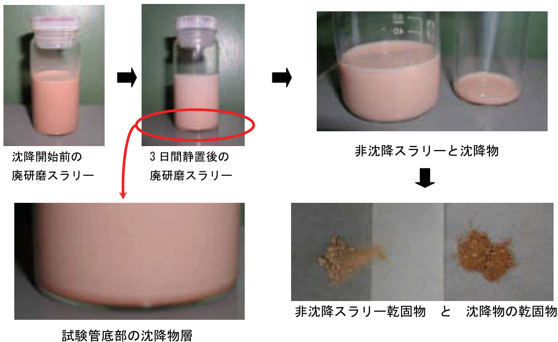
図1 廃研磨スラリーからの沈降試験
