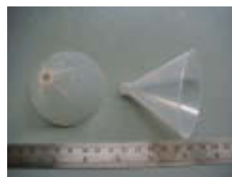
図 17 脚部切断漏斗と沈降装置モデル
