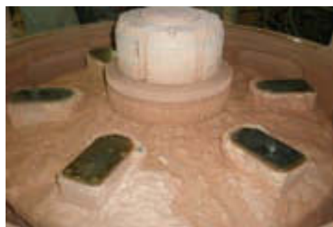
図19 研磨機内部に付着した研磨材
