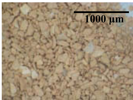
図4 ふるい（目開き 125 \mu\text{m} ）上残留物
