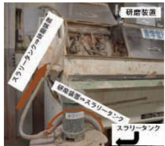
図3 研磨における研磨スラリーの流れ
