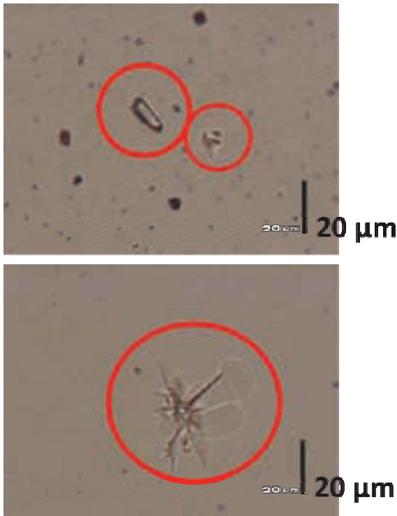
図3 使用後スラリー中の異物の光学顕微鏡像 成分分析の結果、ガラス片と推定されている
