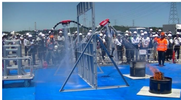
当該発明により開発した空飛ぶ消火ホースロボット
