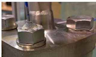
図3 ボルトへの熱電対の取付状況
