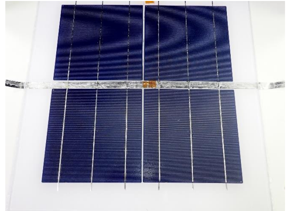
図1 5 温度測定用のミニモジュール
